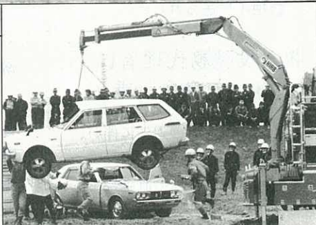
④消防工作車のクレーンで事故処理
